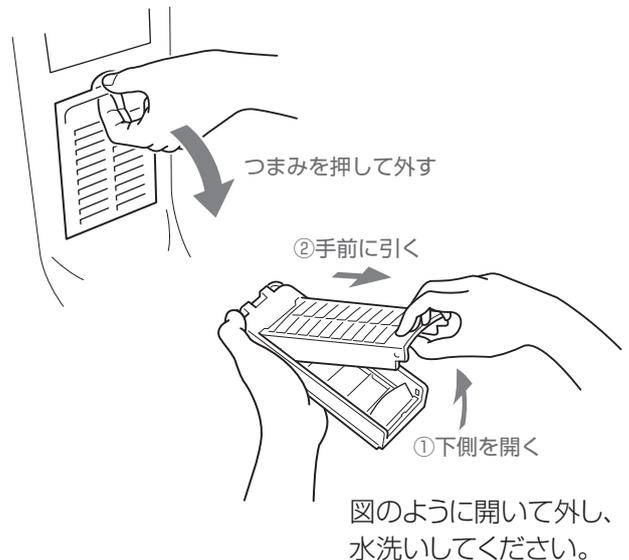
取り付けは、糸くずフィルターの下部を差し込んでから取り付けてください。
