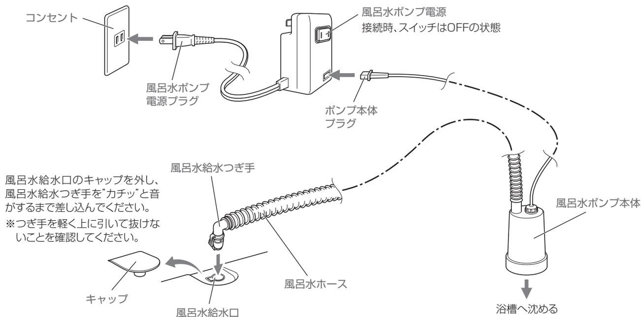
上記の状態、風呂水ポンプ電源のスイッチを「ON」にして、風呂水給水つぎ手と風呂水ホースの接続部分から漏水がないかを確認してください。
