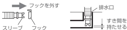
※排水ホースは排水時の水の力や振動などで動くことがあるため、排水口にしっかりと差し込み抜けしないことを確認してください。
